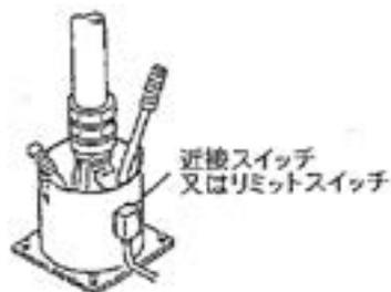
例2 クランプ式ノズル格納具の場合
