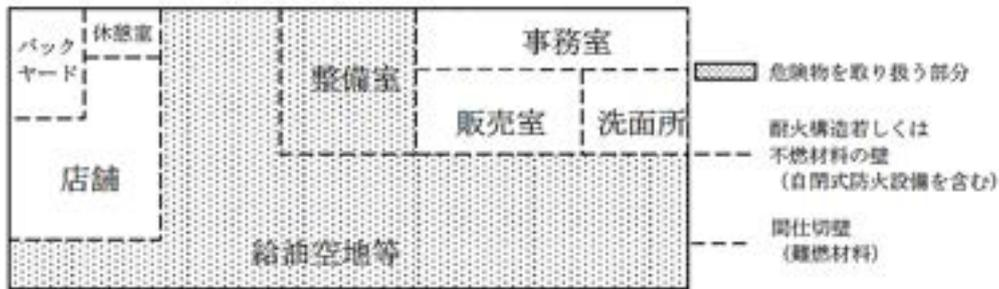
第12-17図 不燃材料以外の建築材料で造ることのできる間仕切壁の例
